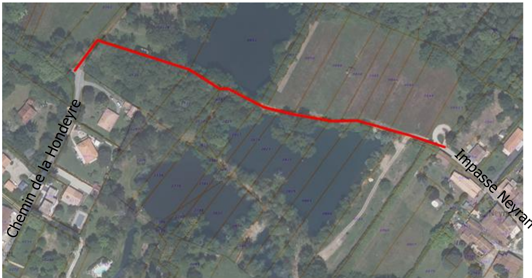
Phase 1 – Conduite de refoulement
